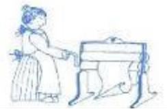
Gerät mit Kurbel zum Auswringen (schnellem Trocknen) der Wäsche
